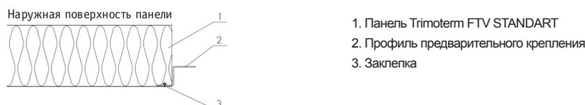
Рис. 21: Профили временного крепления (длина профиля 120 мм)
