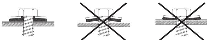
Рис.29: Снятие пленки в месте крепления
