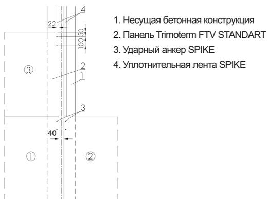
1. Несущая бетонная конструкция
